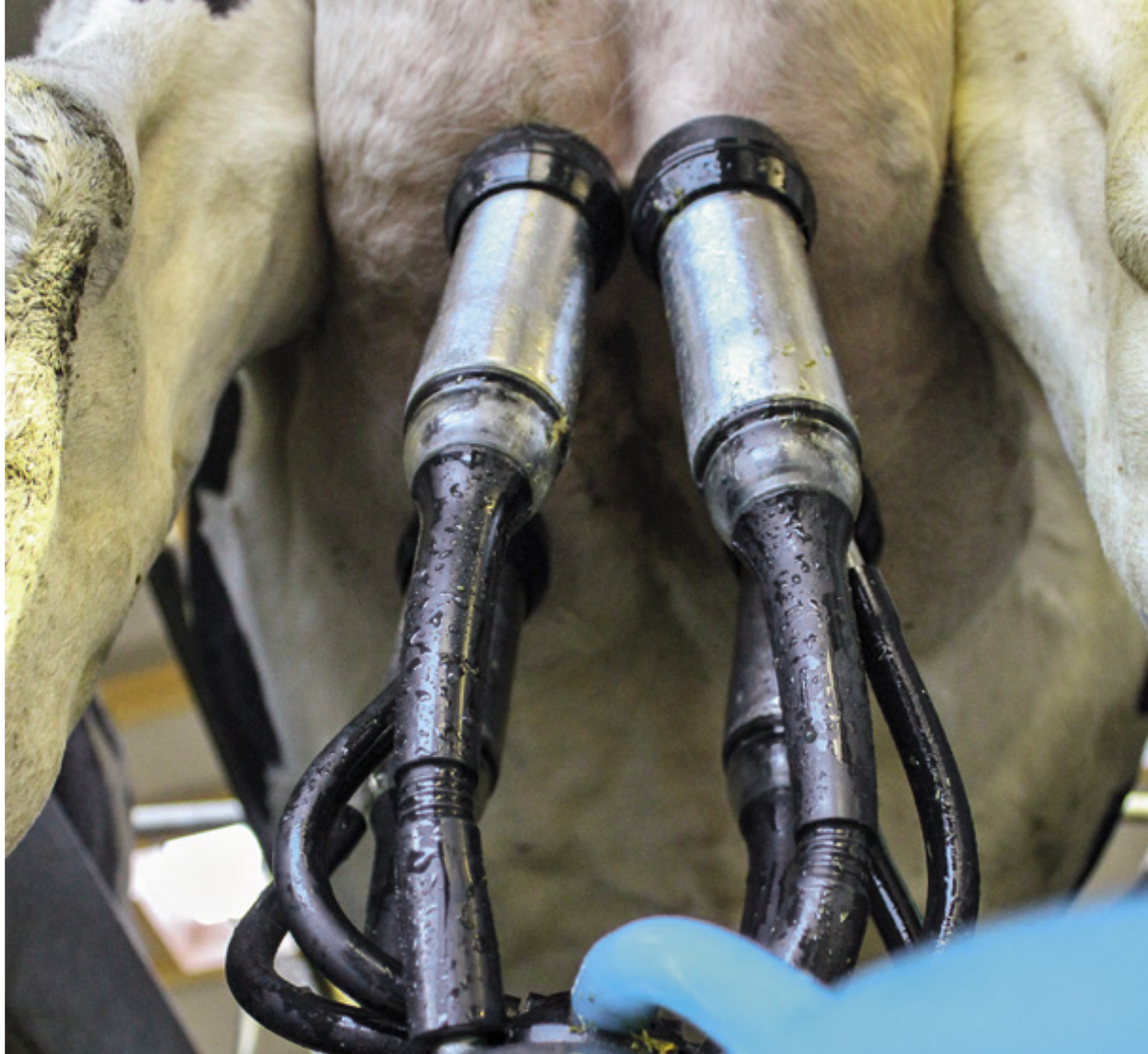
Die Euter sind beim Melken einer hohen Belastung ausgesetzt. Diese lässt sich durch die richtige Vakuumeinstellung und den Einsatz auf die Herde abgestimmter Zitzengummis vermindern.
