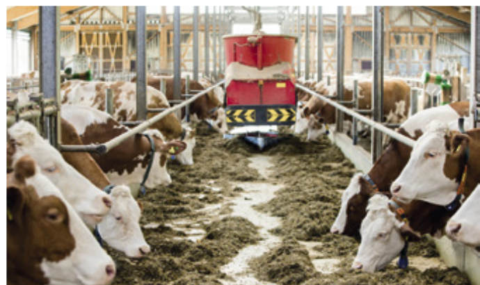
Bis zu sechs Mal täglich legt der Roboter den melkenden Kühen frisches Futter vor.
